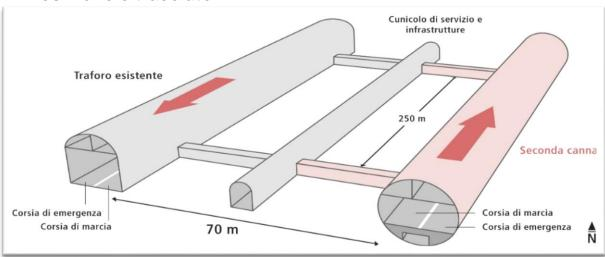
La seconda canna stradale del San Gottardo sarà realizzata 70 metri a est dal tunnel esistente. Il cunicolo infrastrutturale e di servizio, già presente, verrà a trovarsi fra i due trafori paralleli, che saranno collegati a loro volta ogni 250 m da appositi passaggi.
